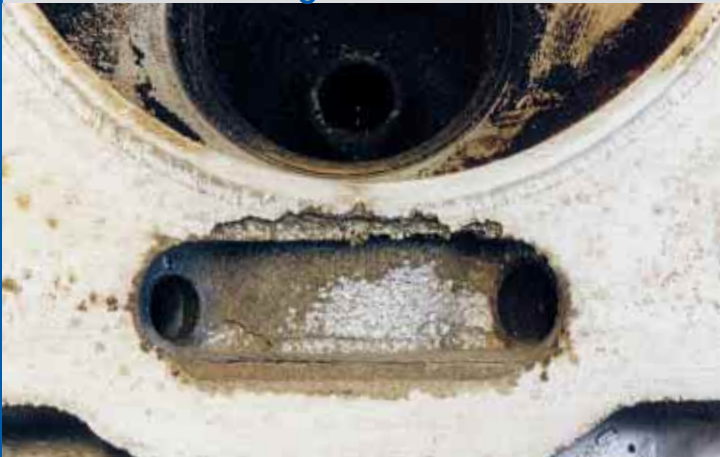
Beispiel: Zylinderkopf mit Korrosionsspuren
